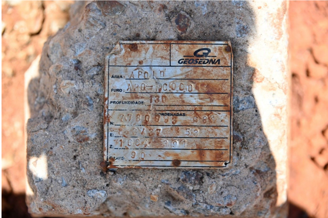
Inscrição na pedra que cobre os furos de sondagem
