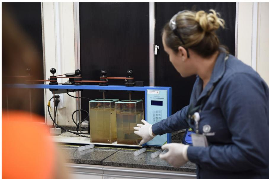
**Figura 6: Ensaio laboratorial de redução da turbidez**
